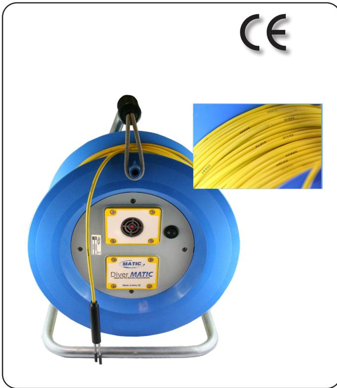
Segnalatore portatile, acustico e visivo, per la misurazione della profondità del livello dell'acqua, munito di cavo metrico, contrassegnato da una scala 0-200 m e avvolgitore con staffa.
